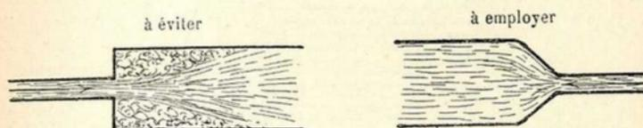
Fig. 3. — Disposition des conduites d'écoulement des fluides.
